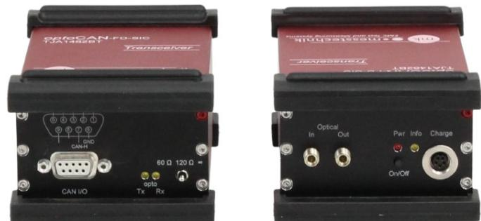
Die beiden Transceiver werden mit einem integrierten Akku versorgt und durch einen Lichtwellenleiter verbunden. Aufgrund der optischen Übertragung und des Schirmgehäuses eignet sich das System sehr gut für die Übertragung von Signalen bei Störfestigkeits- und Störemissionstests nach Automobilstandards wie z.B. CISPR 25 Klasse 5.
