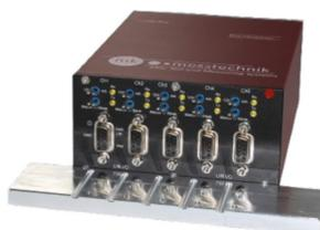
**Lichtwellenleiter - Typen:** FSMA, ST, FC, LC, E2000 (viele Kombinationen möglich), 62.5/125 µm oder 50 µm
